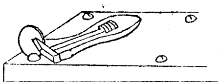
Фиг. 228. Отвинчивание заевших винтов.
